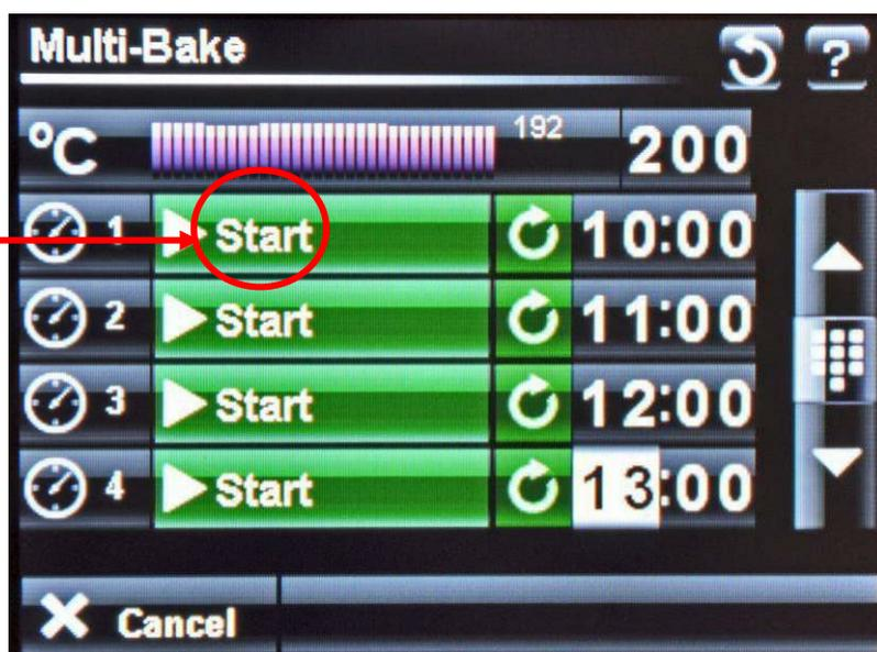
ЭКРАН НАСТРОЙКИ МУЛЬТИ-ВЫПЕЧКИ ОТОБРАЖАЕТ ЧЕТЫРЕ УСТАНОВЛЕННЫХ ТАЙМЕРА
