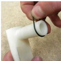
METTRE LE 1er JOINT SUR L'EMBOUT
