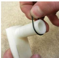
METTRE LE 1er JOINT SUR L'EMBOUT
