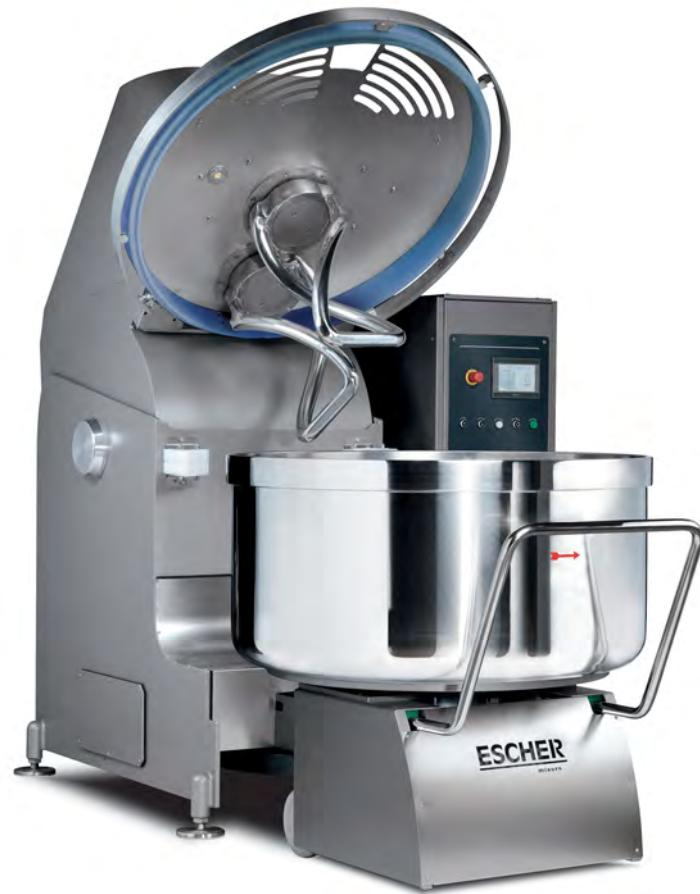
Die Baureihe MW umfasst Mischer mit ausfahrbarem Kessel und doppeltem Mischwerkzeug. Der Kesselantrieb ist für diese Maschinen in zwei Ausführungen erhältlich, und zwar mit dem konischen Patentsystem zur Arretierung und Bewegung des Kessels oder mit dem traditionellen System, das Klammern und ein doppeltes Reibrad aufweist. Verglichen mit anderen Mischsystemen bieten diese Maschine wesentliche Vorteile bei der Teiggüte:
