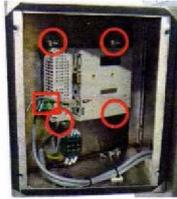
Débranchez le câble d'alimentation de l'IHM et retirez l'ancienne IHM en desserrant et en retirant les 4 vis de fixation à l'aide d'un petit tournevis à tête plate. Poussez ensuite l'IHM hors de la découpe.
