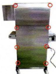
Retirez les 8 vis qui fixent le couvercle du boîtier principal pour accéder au panneau de commande électrique.
