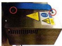
Pour accéder au moteur du plateau, retirez la plaque de recouvrement. Il y a 2 vis sur le dessus et 2 vis sur le dessous
