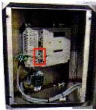
Retirez le câble Modbus du connecteur RS485 de l'IHM en appuyant sur la petite languette du connecteur et en tirant.
