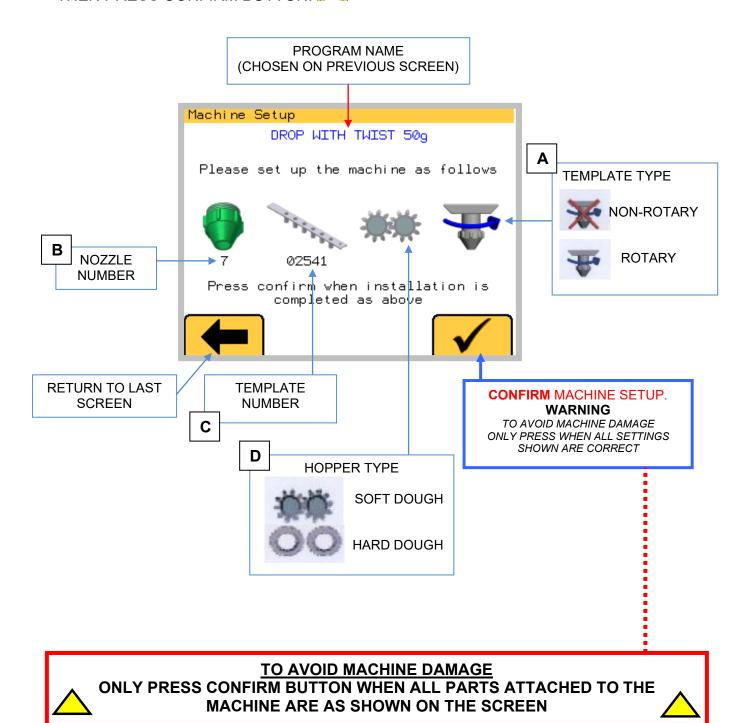
MACHINE SHOULD BE SET AS SHOWN ON THE SCREEN.
