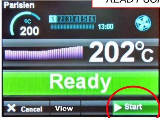
WHEN THE OVEN IS AT THE CORRECT TEMPERATURE, THE "READY" SCREEN WILL SHOW.
