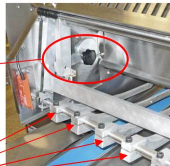
BOLZEN ZUR FINGERAUSRICHTUNG
