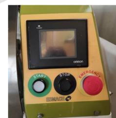
Pannello comandi a 2 velocità con Timer e programmabile tramite Touch screen
