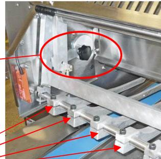
BOLZEN ZUR FINGERAUSRICHTUNG
