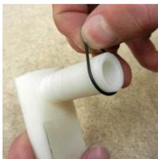
METTRE LE 1er JOINT SUR L'EMBOUT
